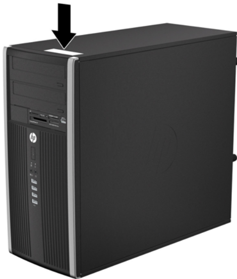
Рисунок 1-8 Розміщення серійного номера й ідентифікаційного коду виробу на Microtower
