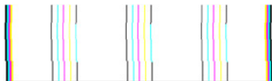
Eksempel på dårlig justeringsmønster Linjene er ujevne - juster skriveren. Hvis det ikke hjelper, kontakter du HP. Hvis du vil vite mer om hvordan du kontakter HP, kan du se HPs kundestøtte .
