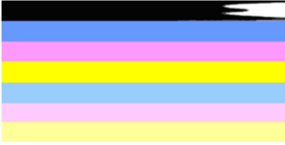
Kötü Renk Çubukları Örneği | Üst çubuk düzensiz olarak çizgili veya soluk.
