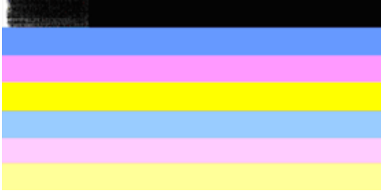
Kötü Renk Çubukları Örneği | Üst siyah çubuğun bir ucu düzensiz.
