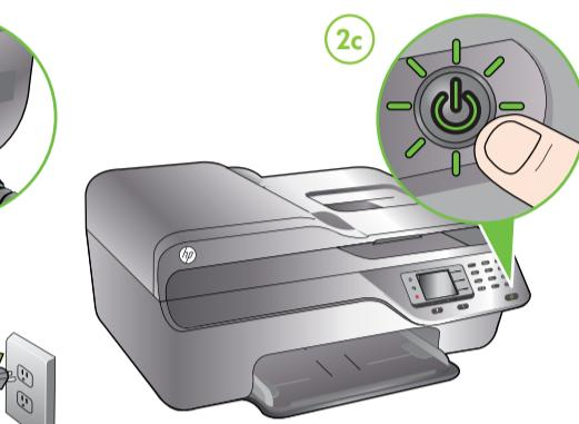
(ID) Hubungkan kabel daya dan hidupkan printer.
