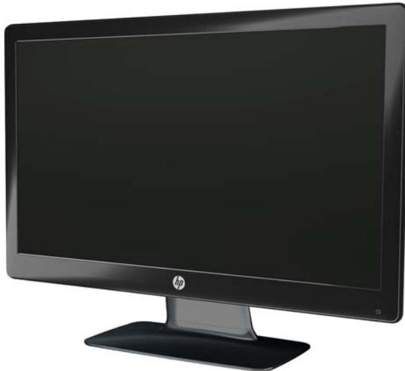
Die HP LCD-Monitore (Liquid Crystal Display) verfügen über einen Bildschirm mit Aktivmatrix- und TFT-Technologie (Dünnschichttransistor) mit LED-Hintergrundbeleuchtung und den folgenden Merkmalen:
