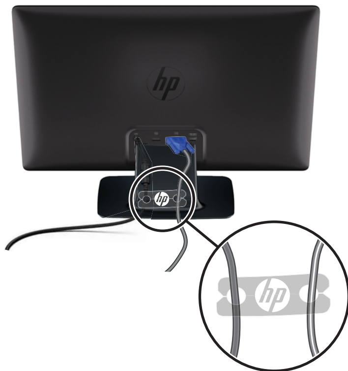
Figur 3-7 Installation af kabelholderklemmen
