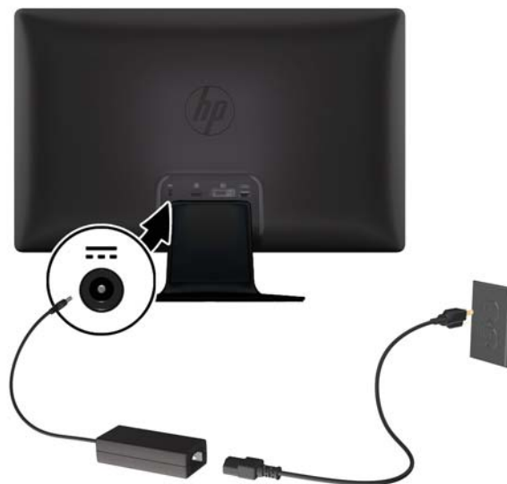
Figur 3-6 Tilslutning af strømkalet
