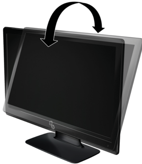
Figur 3-8 Justering af skærmens vinkel
