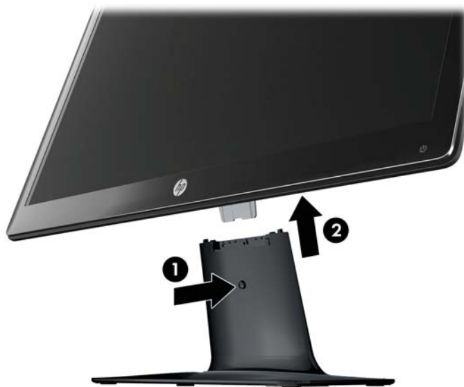
Figura 2-1 Remoção do Monitor
