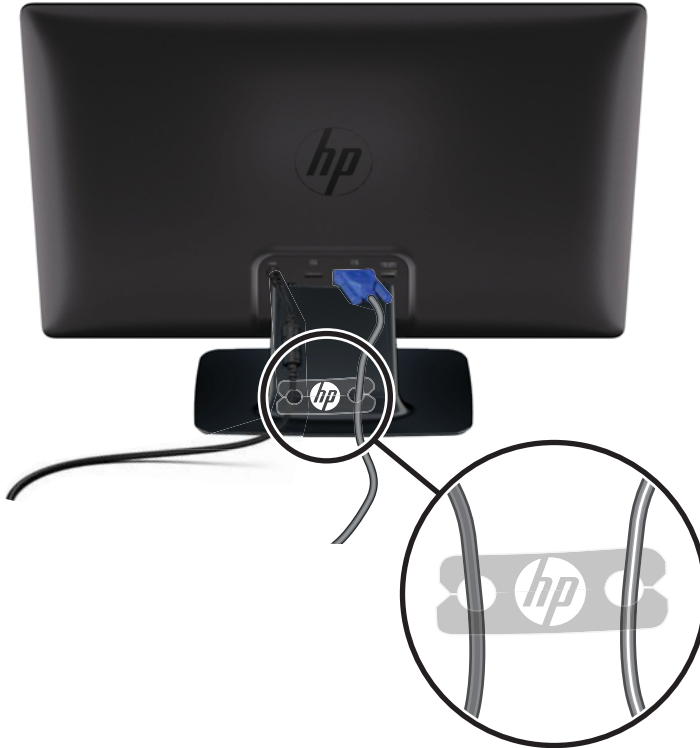
Figura 3-7 Instalação do Clipe de Gerenciamento de Cabo
