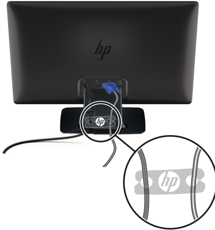
図 3-7 ケーブルマネジメントクリップの取り付け
