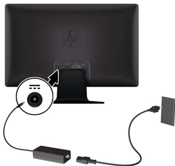
図 3-6 電源コードの接続
