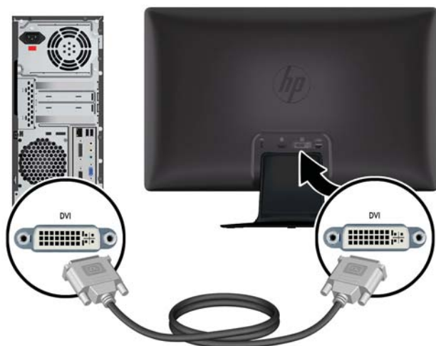
図 3-4 DVI-D ケーブルの接続（ケーブルは一部のモデルにのみ付属）
