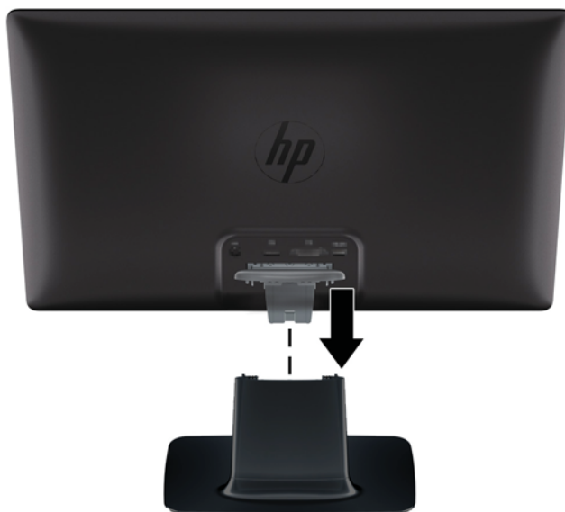
Afbeelding 3-2 Het monitorpaneel plaatsen
