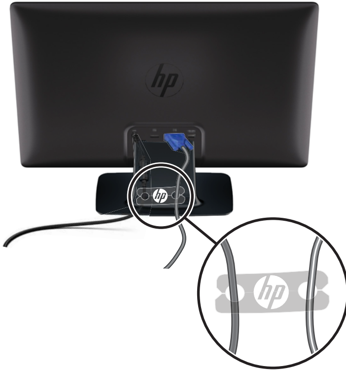
图 3-7 安装电缆管理夹
