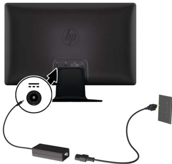
圖示 3-6 連接電源線
