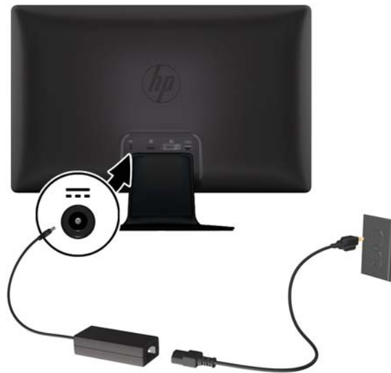
Gambar 3-6 Menyambungkan Kabel Daya
