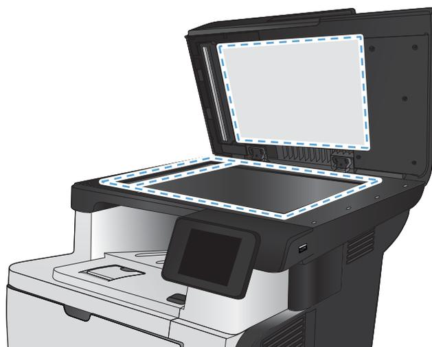
4. Trocknen Sie das Scannerglas und die weißen Kunststoffteile mit einem Ledertuch oder Zellooseschwamm, um Fleckenbildung zu verhindern.
