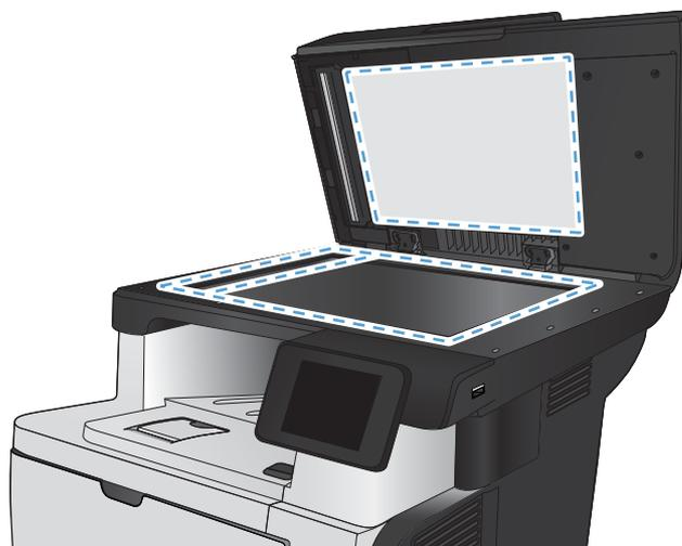
4. Trocknen Sie das Scannerglas und die weißen Kunststoffteile mit einem Ledertuch oder Zelluloseschwamm, um Fleckenbildung zu verhindern.
