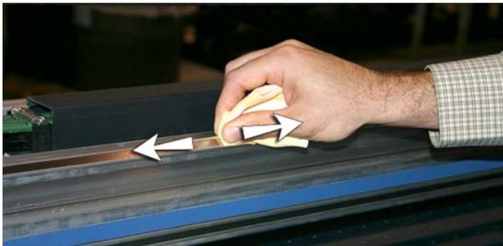
3. Schmieren Sie hinter dem oberen Bereich der Schiene, wo die Schlittenräder Kontakt haben.
