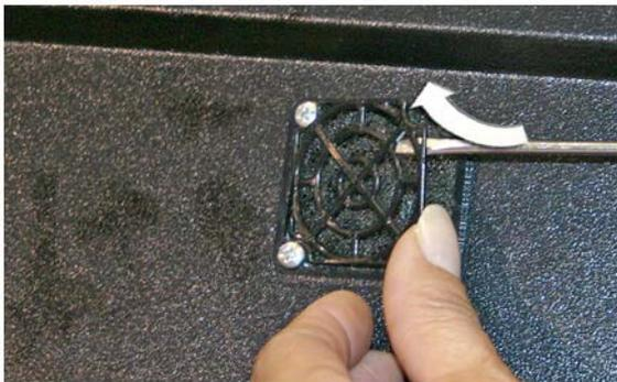
3. Entfernen Sie den ursprünglichen Geblüefilter (A im Foto unten).
