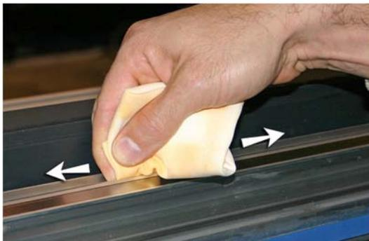
4. Schmieren Sie den unteren Schlittenradstreifen von einem Ende zum anderen (bewegen Sie den Schlitten, um die Schiene in der ganzen Länge zu reinigen.)
