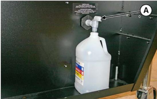
3. Nachdem Sie die Tintenreste abgelassen haben, drehen Sie den Ablaufhahn in die geschlossene Stellung.
