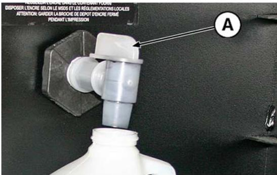
△ **ACHTUNG:** Der Ablaufhahn muss während des Druckens und der Verwendung der Reinigungsstation geschlossen bleiben. Ein geöffneter Ablaufhahn wirkt sich auf den Vakuumpegel in der Reinigungsstation aus und beeinträchtigt die Leistung der Reinigungsstation.
