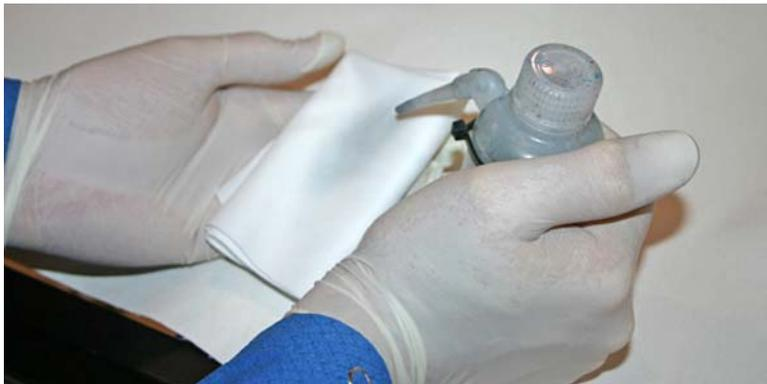
6. Verwenden Sie für jeden Druckkopf einen einzelnen Finger auf einem sauberen Bereich des getränkten fusselfreien Tuchs, um die Druckkopfföffnung von der Innenseite zur Außenseite des Schlittens abzuwischen.
