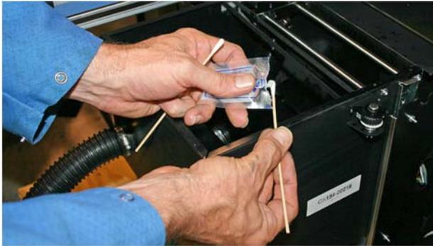
4. Verteilen Sie das Fett auf beiden Schienen (A und B im Foto unten), und stellen Sie sicher, dass Sie die gesamte Oberfläche der Schiene (oben, unten und auf den Seiten) fetten.
