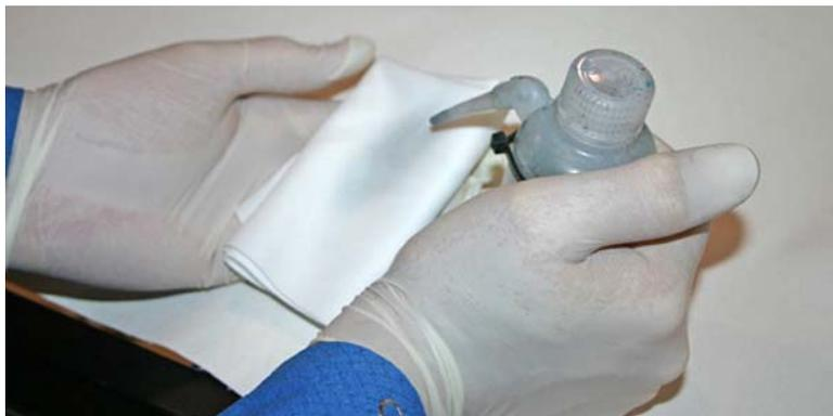
6. Para cada cabezal de impresión, coloque un solo dedo en una parte limpia del paño sin pelusas empapado con líquido limpiador para limpiar el orificio del cabezal de impresión desde la parte interna hasta la parte externa del carro.
