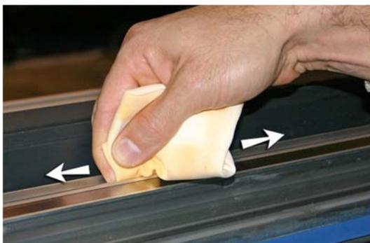
4. Lubrique la correa inferior de las ruedas del carro de extremo a extremo del riel (moviendo el carro para limpiar todo el riel).
