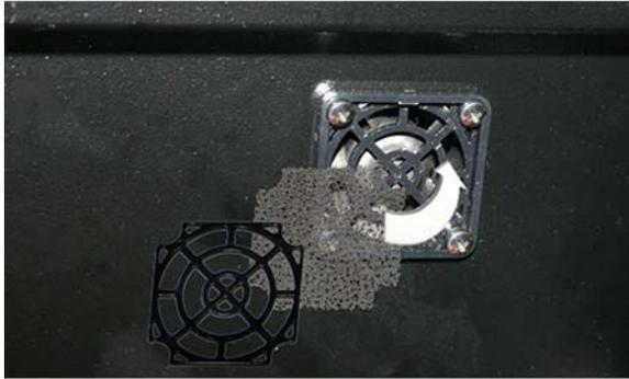
5. Coloque de nuevo la cubierta del filtro del ventilador.
