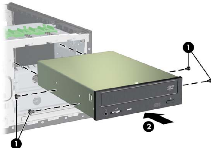
図 5-19 オプティカルドライブの取り付け
