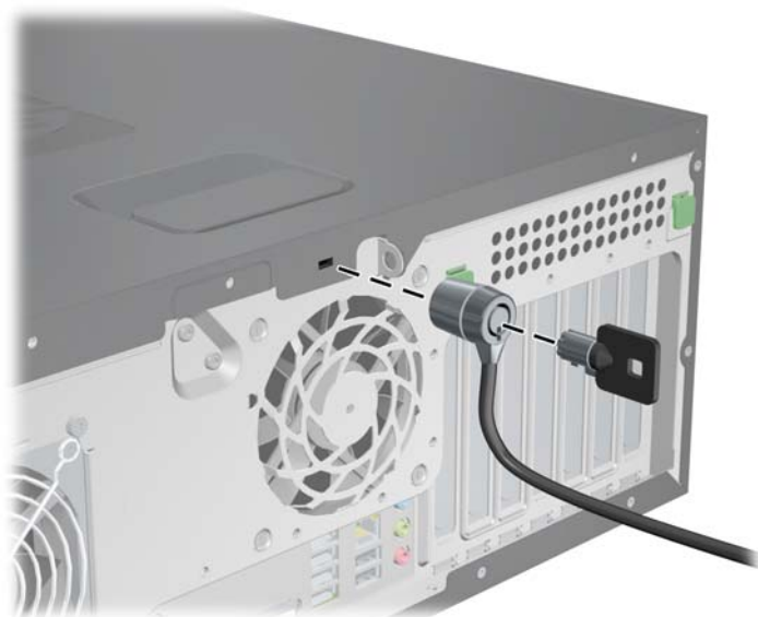
図 5-2 ケーブルロックの取り外し
