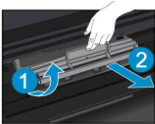
3. Pulse en el hueco de la cubierta de ruta del duplexor para levantarla. Extraiga el papel atascado.
