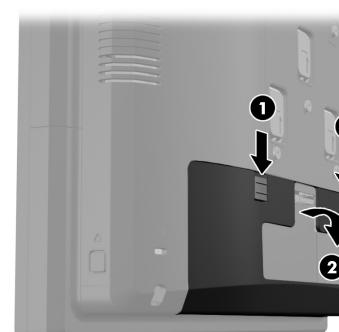
6. Ouvrez la petite trappe située à la base du logement de la source d'alimentation **①** et insérez le boîtier d'alimentation dans le logement **②**.
