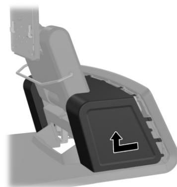
2. Lepaskan panel dekoratif pada bagian belakang unit dengan mengungkit panel perlahan-lahan menjauh dari dasar unit, pada lokasi tab di bagian atas dan samping panel seperti yang ditunjukkan di bawah ini ①. Lalu tarik bagian atas panel menjauh dari dasar unit ② dan dorong panel ke arah bawah untuk melepaskan tab bagian bawah ③.
