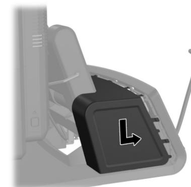
12. Pasang kembali penutup I/O belakang dengan menempatkan kait pada bagian bawah penutup ke dalam slot pada bagian bawah casing ①. Lalu putar bagian atas penutup I/O ke atas hingga terpasang dengan kuat pada casing ②.
