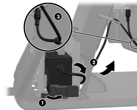
8. Arahkan kabel daya AC melalui bagian bawah dari dasar dudukan, lalu melalui rongga pada bagian dasar dudukan, dan sambungkan kabel ke catu daya. Masukkan kabel ke klip penahan kabel pada sisi bagian bawah dan sambungkan ujung kabel lainnya ke stopkontak listrik.
