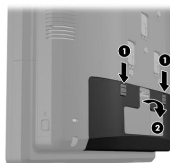
4. Pasang panel layar RP7 ke braket penahan dudukan dengan cara menyejajarkan slot pada panel layar dengan kaitan pada braket penahan, dan geser layar ke arah bawah ①. Pasang tiga sekrup yang disertakan dengan dudukan melalui braket penahan ke dalam panel layar untuk mengencangkannya ②.
