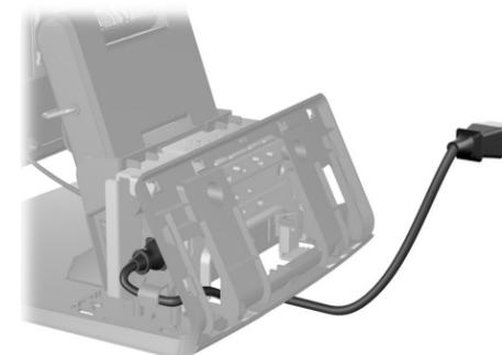
9. Arahkan kabel ke perangkat periferil melalui bagian bawah belakang dari dasar unit, melalui lubang pada bagian tengah dasar unit, lalu naik melalui penahan kabel pada leher dudukan dan ke dalam port I/O yang sesuai.
