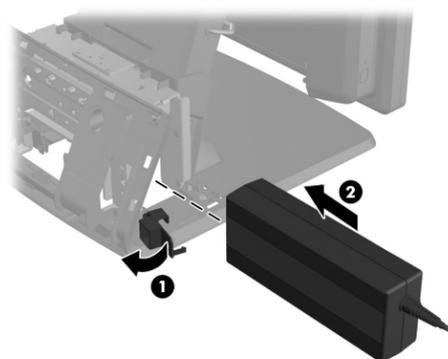
7. Tutup pintu kecil pada bagian bawah rangka catu daya ①. Arahkan kabel catu daya melalui sisi dasar unit, lalu keluar melalui bagian tengah dasar unit ② dan naik melalui penahan kabel pada leher dudukan. Masukkan kabel ke dalam klip penahan kabel di sebelah port daya ③ dan sambungkan kabel ke port daya masukan DC.
