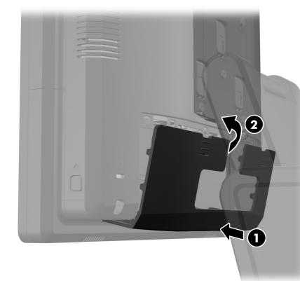
3. Retirez le panneau décoratif situé à l'arrière de l'unité en faisant levier pour déloger délicatement le panneau hors de la base à l'emplacement des languettes sur le haut et les côtés du panneau comme indiqué ci-dessous ①. Puis tirez le haut du panneau hors de la base ② et poussez le panneau vers le bas pour libérer les languettes inférieures ③.
