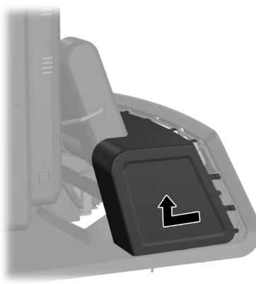
5. Acheminez les câbles audio, DVI, USB et d'alimentation par l'orifice de la plaque arrière de l'afficheur client ①. Connectez la plaque arrière à l'afficheur client en alignant les crochets de la plaque arrière avec les logements situés à l'arrière de l'écran et en faisant glisser la plaque vers le haut ② de sorte que les trous de vis sur la plaque arrière soient alignés avec les trous des vis de l'afficheur. Installez les deux vis pour fixer la plaque arrière à l'afficheur ③.
