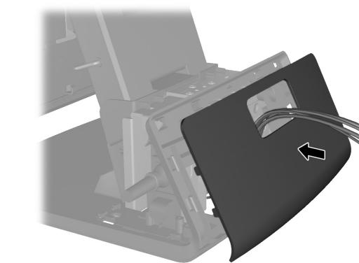
11. Remettez en place le cache des E/S en insérant les languettes au bas du cache dans les logements à la base du châssis ① et en faisant pivoter le haut du cache pour qu'il s'enclenche sur le châssis ②.
