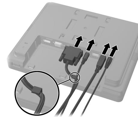
7. Guidez les câbles audio, DVI, USB et d'alimentation à travers l'arrière de la base pour les faire sortir à l'avant ; faites-les ensuite passer par le collier situé sur le support du socle RP7 et connectez-les aux ports E/S du RP7.
