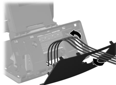
7. Voer de audio-, DVI-, USB- en voedingskabels door de achterkant van de basis naar de voorkant van de basis en daarna door kabelhouder op de hals van de RP7-standaard. Sluit de kabels aan op de RP7 in- en uitgangspoorten.
