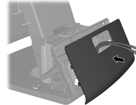
9. Schuif de montagebeugel van het achterpaneel in de montageopening op de achterkant van de RP7-basis ❶ en plaats de twee met het klantenschermb meegeleverde schroeven in de schroefgaten boven in de montagebeugel ❷.
