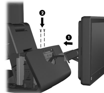
10. Zet de afdekking van de voedingsbron terug door deze over de hals van de basis te laten zakken en daarna terug te schuiven tot hij op zijn plaats klikt.
