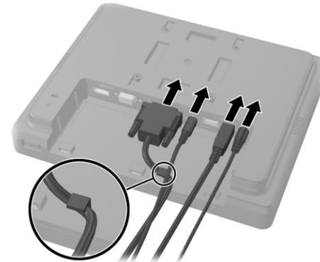
5. Leid de audio-, DVI-, USB- en voedingskabels door het gat in het achterpaneel van het klantenschermb ❶. Sluit het achterpaneel aan op het klantenschermb door de haken op de achterplaat uit te lijnen met de sleuven op de achterkant van het scherm en het achterpaneel omhoog te schuiven ❷, zodat de schroefgaten op het achterpaneel zijn uitgelijnd met de schroefgaten op het scherm. Plaats de twee schroeven en schroef het achterpaneel aan het scherm vast ❸.
