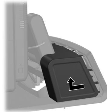
3. Verwijder de decoratieve afdekplaat aan de achterkant van de unit door de plaat voorzichtig los te wrikken van de basis bij de lipjes aan de boven- en zijkant van de plaat, zoals hieronder wordt getoond ❶. Trek vervolgens de bovenkant van de afdekplaat van de basis af ❷ en duw recht omlaag op de plaat om de onderste lipjes vrij te geven ❸.
