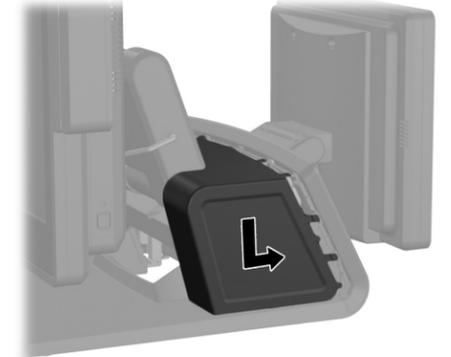
11. Plaats het achterste I/O-klepje terug door de haken onder aan de afdekplaat in de sleuven onder aan het chassis te plaatsen ❶. Draai vervolgens de bovenkant van het I/O-klepje omhoog zodat het stevig vastklikt op het chassis ❷.
