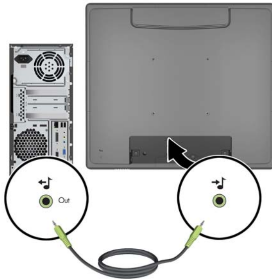
Figur 2-24 Tilslutning af lyd-kablet
