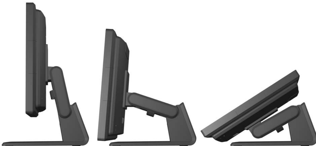
Figur 2-19 Justering af det valgfri skærmstativ
