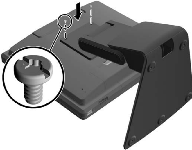
Kuva 2-15 Ylempien kiinnitysruuvien asentaminen
