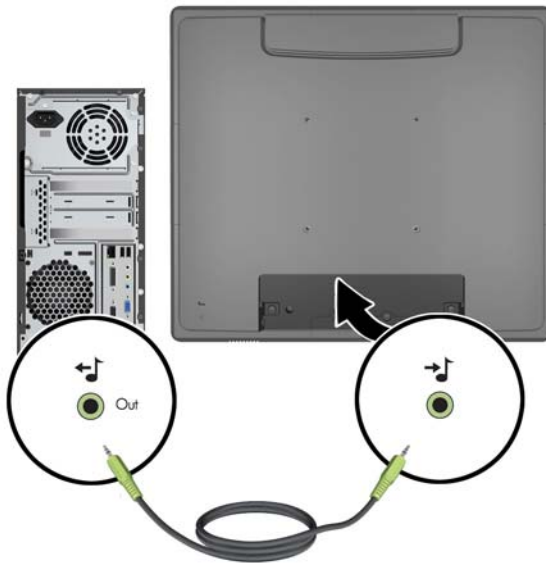
Slika 2-24 Priključitev zvočnega kabla
