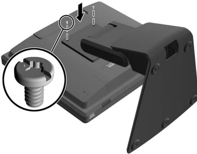
Figura 2-15 Instalación de los tornillos de montaje superiores
