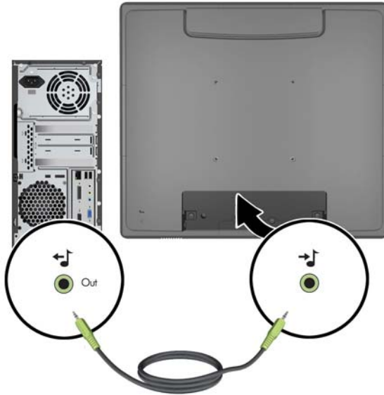
Figura 2-24 Conexión del cable de audio
