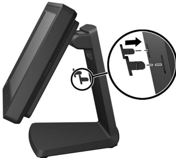
Abbildung 2-8 Wiederanbringen der Zugangsstöpsel
