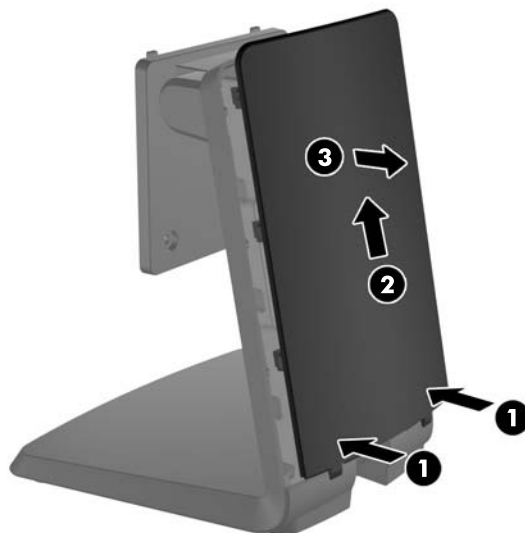
Abbildung 2-3 Entfernen der rückseitigen Abdeckung
