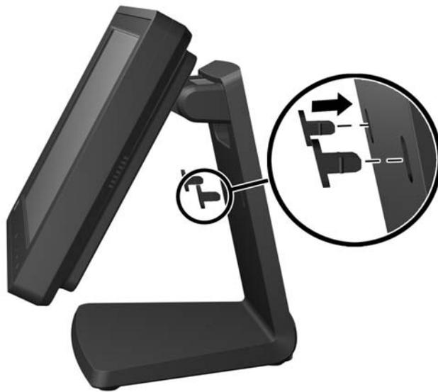
7. Far passare i cavi attraverso il foro superiore di accesso al cavo, in alto nel supporto, dietro le staffe di protezione del cavo e farli uscire dal foro di accesso nel fondo del supporto.
