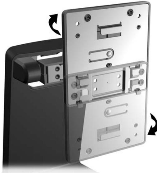
3. Riavvitare le quattro viti Philips di fissaggio della staffa di montaggio al supporto in modo da fissare la staffa al supporto.
