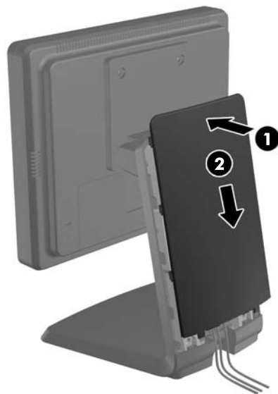
Bild 2-19 Sätta tillbaka bakskyddet
