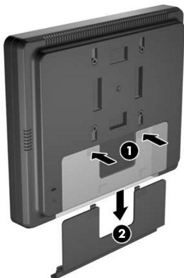
Bild 2-21 Ta bort kabelskyddet
