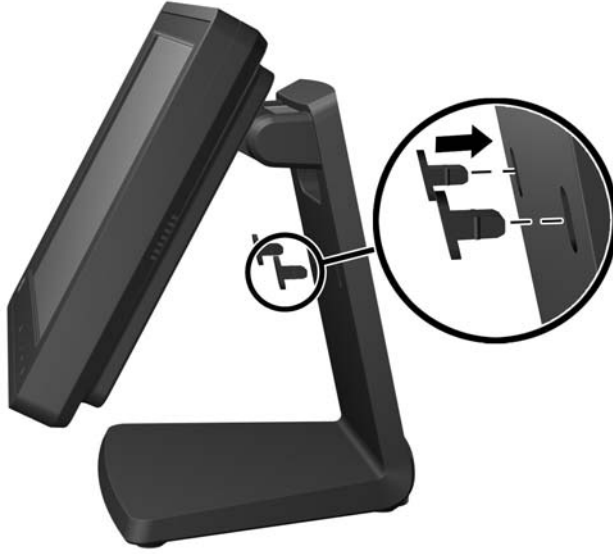
Şekil 2-8 Erişim Tapalarını Yeniden Yerleştirilmesi
