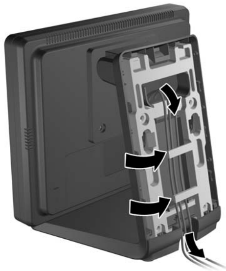
Rysunek 2-9 Prowadzenie kabli
