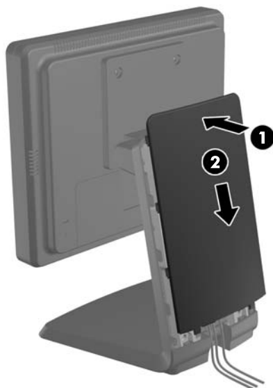
Rysunek 2-19 Zakładanie tylnej pokrywy
