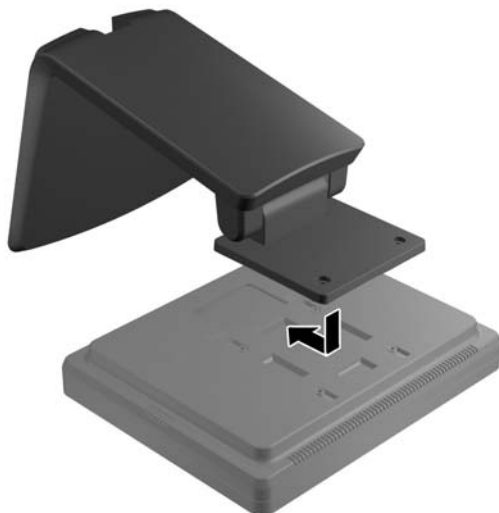
Rysunek 2-15 Zakładanie podstawy
