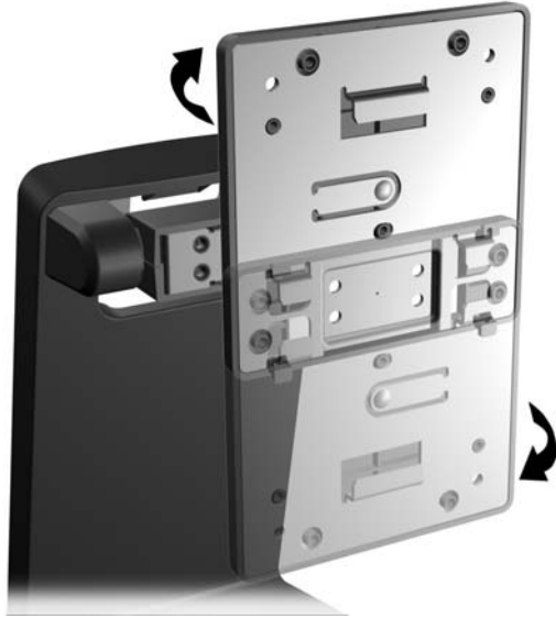
Rysunek 2-12 Obracanie wspornika montażowego o 180°
