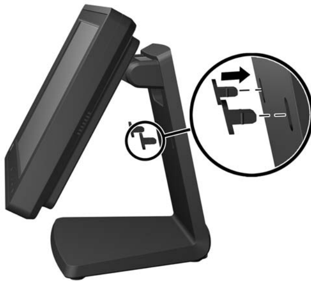
Rysunek 2-8 Zakładanie zaślepek dostępowych
