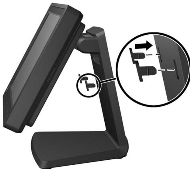
7. ケーブルが、スタンド上部のスペースから出て、ケーブルを押さえておくためのブラケットの内側を通り、スタンド下部のスペースから出るように配線します。
