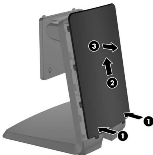
2. ネジを取り付けられるようにするために、スタンド中央にある2つのプラグを、裏側のタブをはさむようにつまみ (1)、スタンドの表側から引き出して (2) 取り外します。
