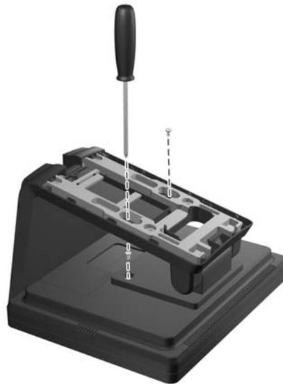
6. モニターを直立させた状態で、手順 2 で取り外したプラグをスタンドに取り付けなおします。
