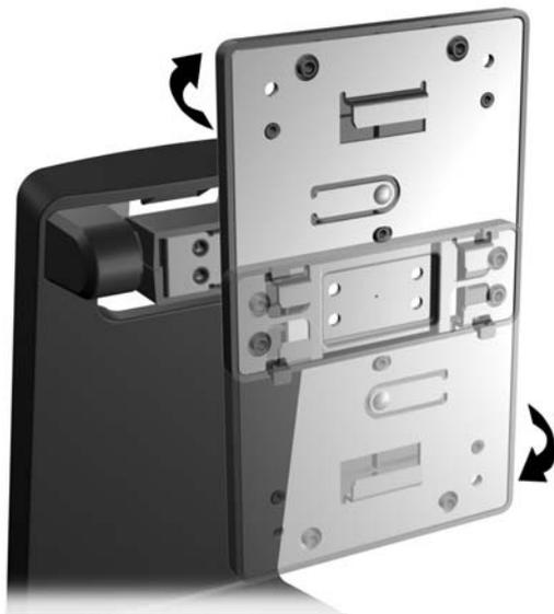
3. 手順 1 で取り外した 4 つのプラスのネジを取り付けなおして、ブラケットをスタンドに固定します。
