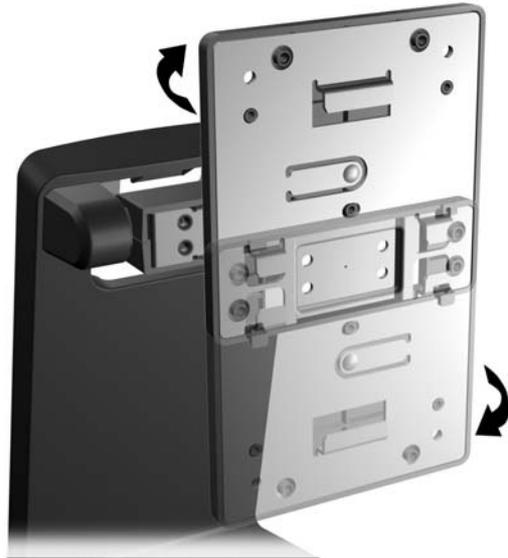
3. Vuelva a colocar los cuatro tornillos Phillips que sujetan el soporte de montaje a la base para asegurar el soporte a la base.
