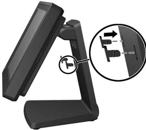
7. Pase los cables a través del orificio de acceso superior del cable en la parte superior de la base, detrás de los soportes de seguridad del cable y hacia fuera del orificio de acceso del cable en la parte inferior de la base.
