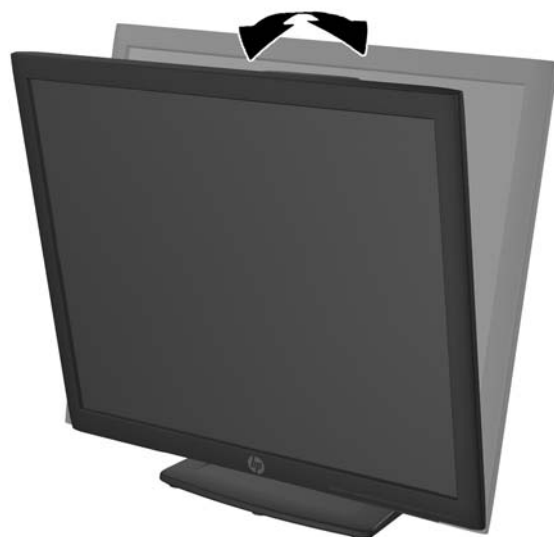
Figure 2-10 Inclinaison du moniteur
