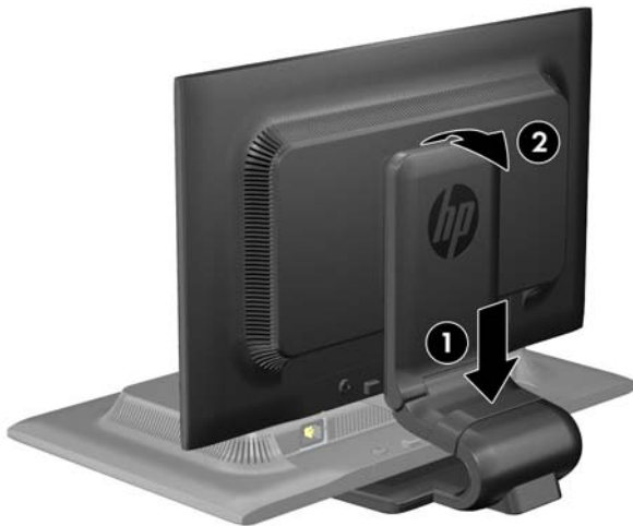
Figura 2-1 Desdoblamiento de la base del pedestal monitor
