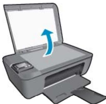
放入原稿，列印面朝下，放在玻璃板的右前方角落。
