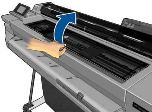
11. Levante la palanca del carro.
