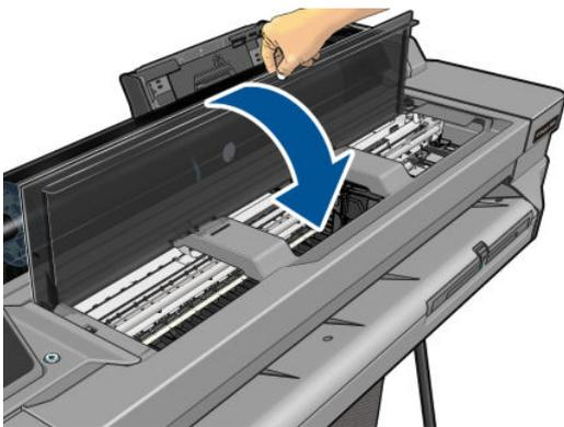
5. Abra la cubierta del rollo y rebobínelo. Puede notar cierta resistencia si el papel está pegado; tire con firmeza.
