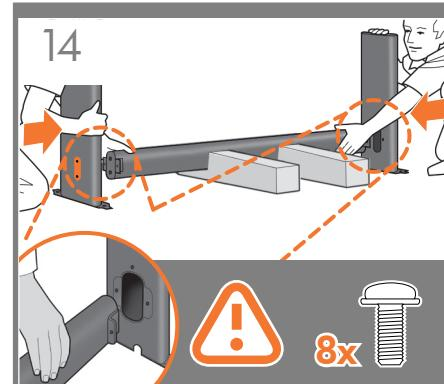
**FR** Vous trouverez un tournevis et 22 vis dans le carton du support : 16 vis pour assembler le support, 4 vis pour le fixer à le produit et **2 vis de rechange**. N'essayez pas de retirer les rondelles des vis. **Remarque** : toutes les vis sont destinées au support. Le bac de réception ne nécessite aucune vis.
