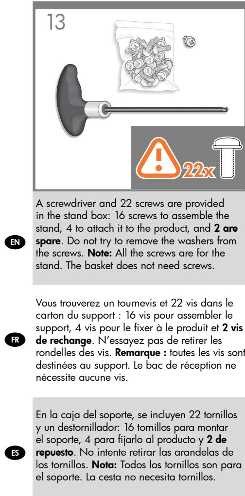
**EN** Uma chave de parafuso e 22 parafusos são fornecidos na caixa do suporte: 16 parafusos para montar o suporte, 4 para fixá-lo no produto e **2 de reserva**. Não tente retirar as arruelas dos parafusos. **Observação:** todos os parafusos são para o suporte. A cesta não precisa de parafusos.
