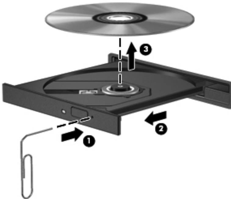
4. Fermez le chargeur et placez le disque dans un boîtier de protection.
