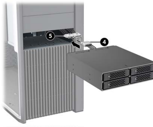
図5 電源ケーブルの接続
