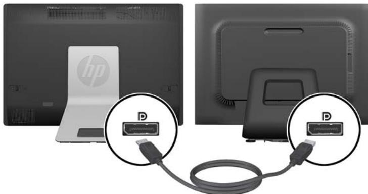
4. Si le second écran n'est pas équipé d'un connecteur DisplayPort, connectez un adaptateur vidéo DisplayPort au connecteur DisplayPort de l'ordinateur. Connectez ensuite un câble (VGA, DVI, ou HDMI, selon votre application) entre l'adaptateur et un second écran.
