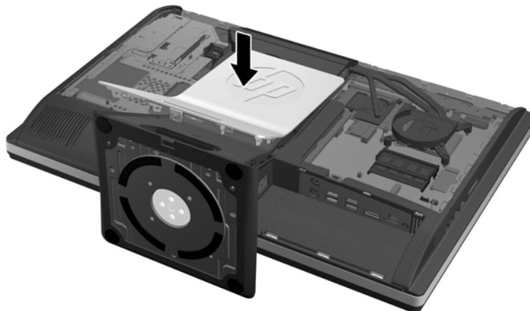
29. Pour remettre le panneau d'accès en place, placez-le à l'arrière de l'ordinateur, légèrement au-dessus du socle, et faites-le glisser en place.
