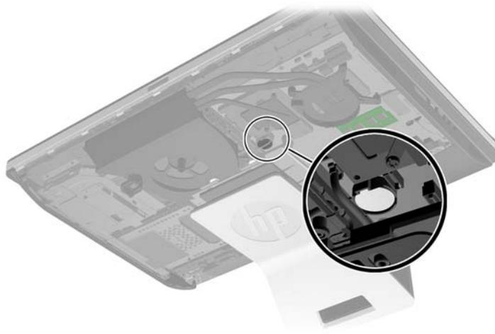
7. Pour libérer la pile de son support, appuyez sur la languette métallique qui bloque le bord de la pile. Lorsque la pile est libérée, retirez-la de son support (1).
