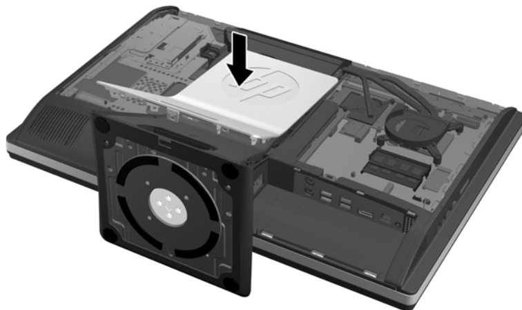
Bild 2-52 Sätta tillbaka baksidan på stället
