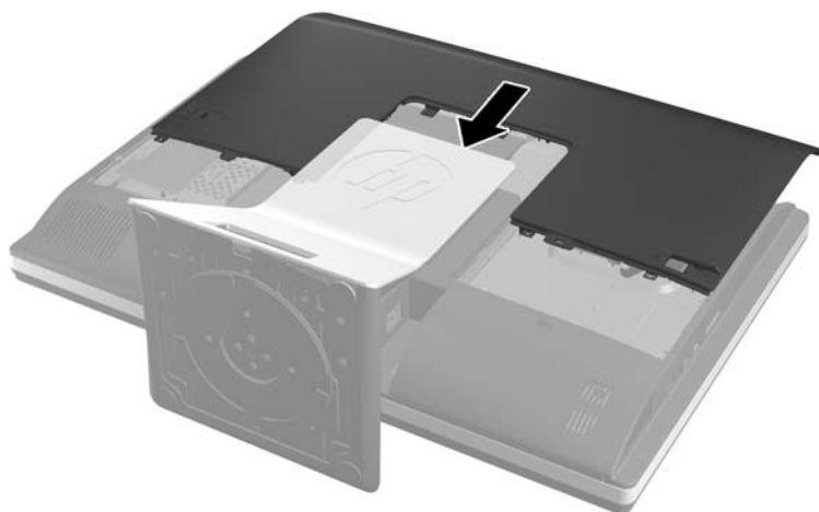
Bild 2-22 Sätta tillbaka åtkomstpanelen
