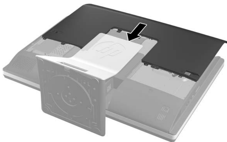
Bild 2-59 Sätta tillbaka datorns åtkomstpanel
