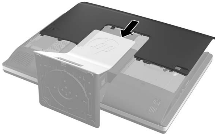
Figura 2-22 Substituir o painel de acesso
