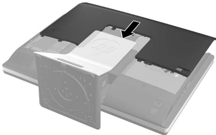
Figura 2-59 Substituir o painel de acesso
