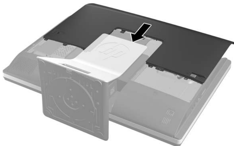
Figura 2-53 Substituir o painel de acesso
