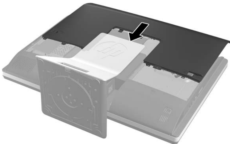
Figura 2-26 Substituir o painel de acesso
