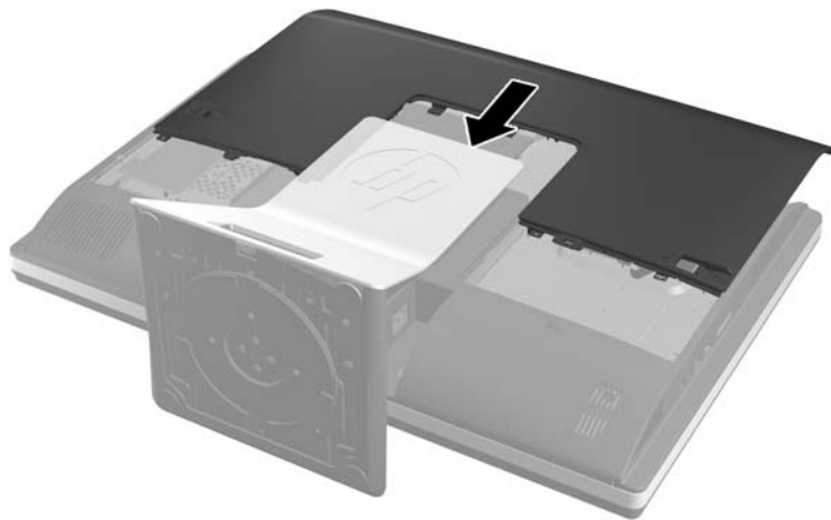
Figura 2-34 Substituir o painel de acesso
