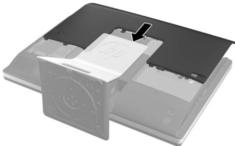
Figura 2-26 Reinstalação do painel de acesso
