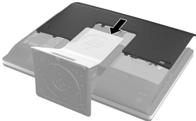
Figura 2-53 Reinstalação do painel de acesso
