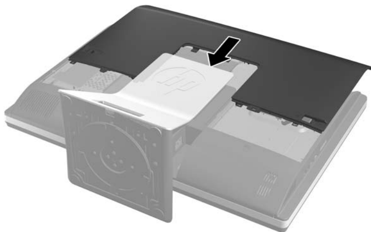
Figura 2-59 Reinstalação do painel de acesso
