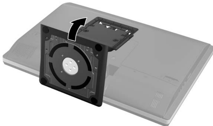
Figura 2-13 Remoção da base
