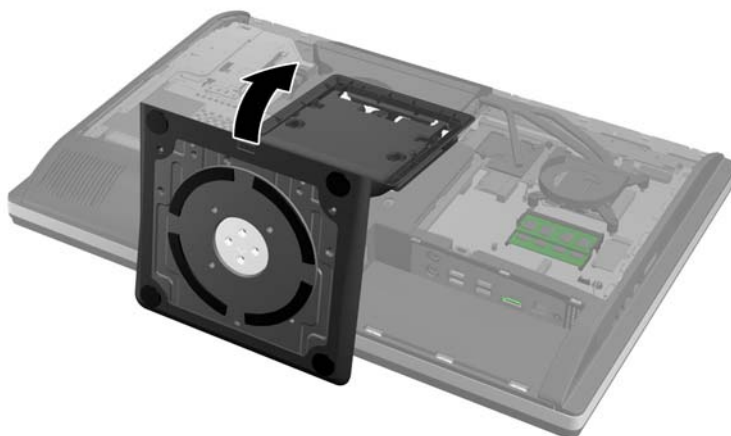
Figura 2-38 Remoção da base
