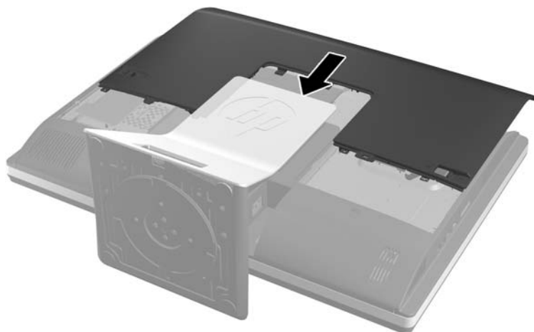
Rysunek 2-34 Zakładanie panelu dostępu
