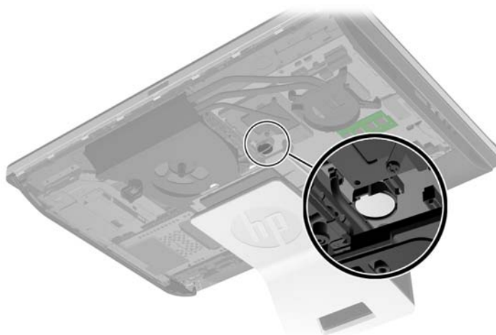
Rysunek 2-24 Odnajdywanie baterii
