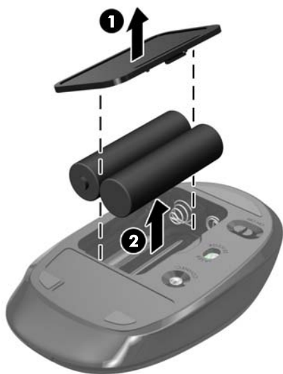
Rysunek 2-10 Wyjmowanie baterii z myszy bezprzewodowej
