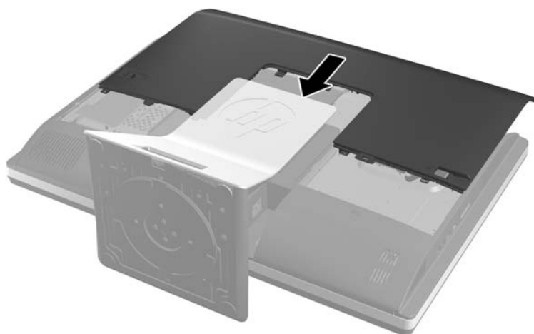
Rysunek 2-59 Zakładanie panelu dostępu
