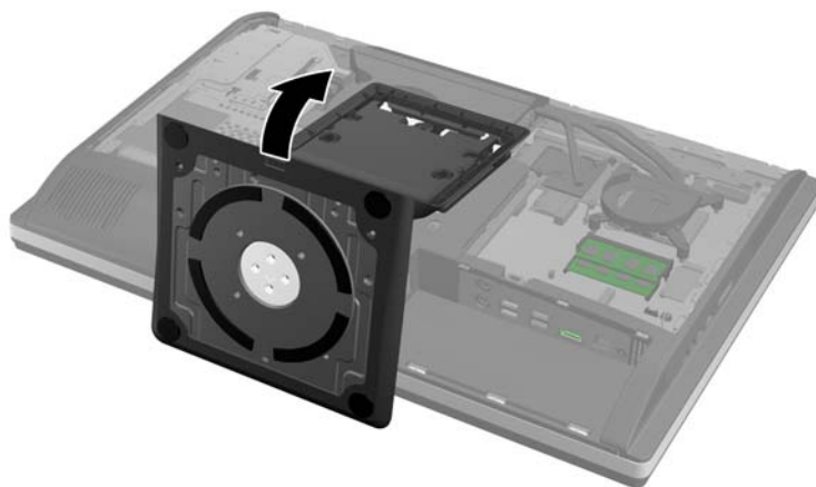
圖示 2-38 拆卸支架
