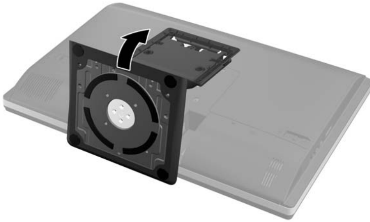
圖示 2-13 拆卸支架
