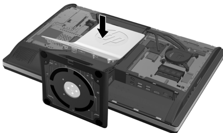
Figura 2-52 Reinstalación de la parte posterior de la base
