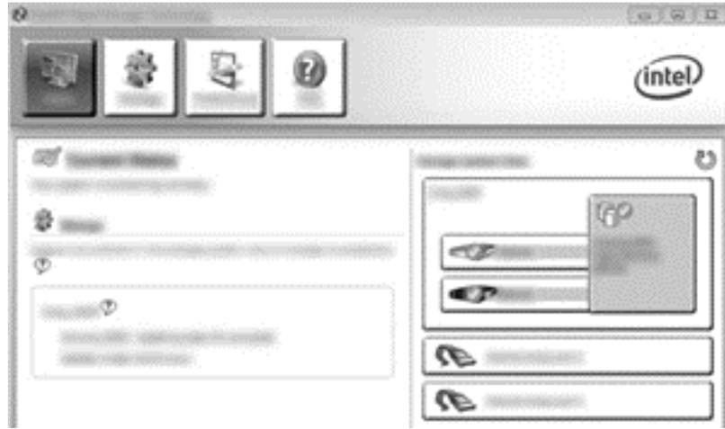
٥. عند إخبارك بأن ترحيل النظام قد تم، أغلق كافة البرامج المفتوحة وأعد تمهيد الكمبيوتر. يعد أن يتم تمهيد الكمبيوتر، يكتشف نظام التشغيل النظام الحديث الإنشاء طالبا إعادة التشغيل مرة أخرى. أعد تشغيل الكمبيوتر عند الطلب. وبعد إعادة التشغيل النهائية سيكون ترحيل RAID قد اكتمل.
