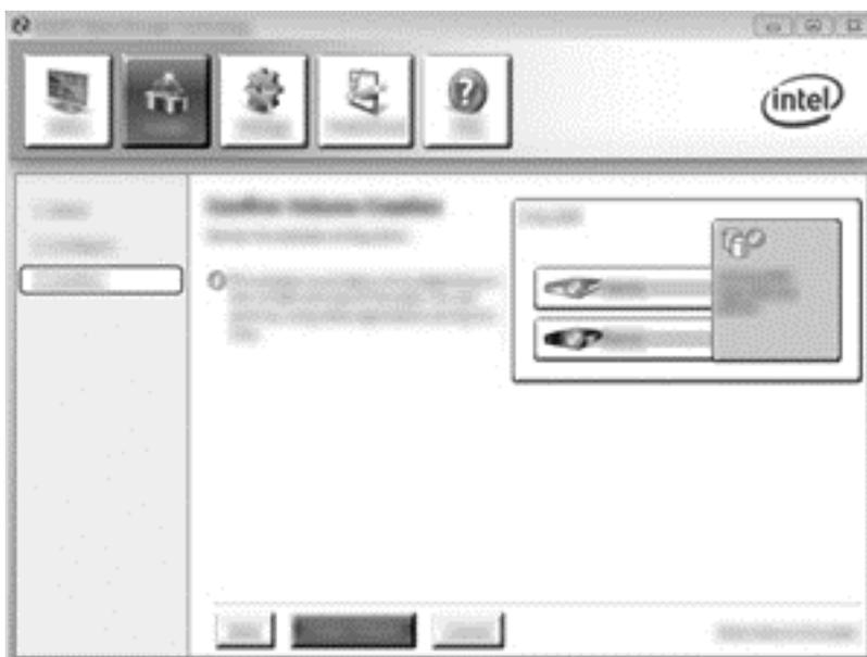
4. **[Create Volume]**ボタンをクリックすると、アレイが作成されたことを知らせるメッセージが表示されます。**[OK]**ボタンをクリックします。アレイの移行はバックグラウンドで引き続き実行されます。移行が実行されている間は、コンピューターを通常どおり使用できます。
