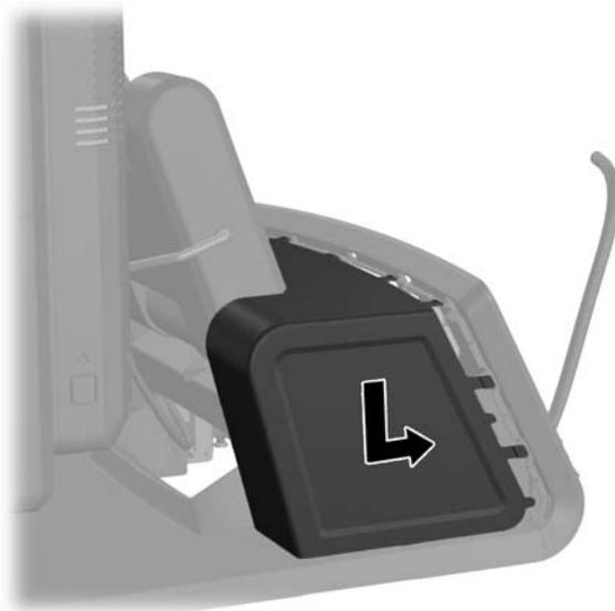
14. Setzen Sie die rückseitige E/A-Abdeckung wieder ein, indem Sie die Haken an der Abdeckungsunterseite in den Schlitz an der Gehäuseunterseite befestigen (1). Drehen Sie dann die Oberseite der E/A-Abdeckung nach oben, so dass sie richtig am Gehäuse einrastet (2).
