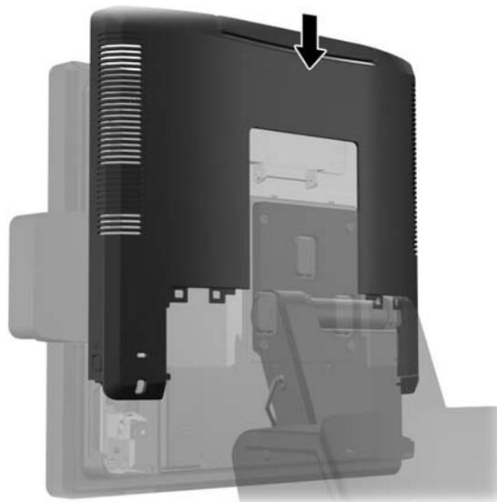
10. Setzen Sie die rückseitige E/A-Abdeckung wieder ein, indem Sie die Haken an der Abdeckungsunterseite in den Schlitz an der Gehäuseunterseite befestigen (1). Drehen Sie dann die Oberseite der E/A-Abdeckung nach oben, so dass sie richtig am Gehäuse einrastet (2).
