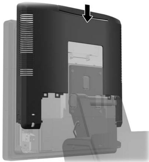
10. Setzen Sie die rückseitige E/A-Abdeckung wieder ein, indem Sie die Haken an der Abdeckungsunterseite in den Schlitz an der Gehäuseunterseite befestigen (1). Drehen Sie dann die Oberseite der E/A-Abdeckung nach oben, so dass sie richtig am Gehäuse einrastet (2).
