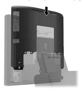
10. Rimettere il coperchio I/O posteriore collocando i ganci situati sul fondo del coperchio negli slot situati sul fondo dello chassis (1). Ruotare quindi verso l'alto il lato superiore del coperchio I/O in modo che scatti in posizione fissa nello chassis (2).
