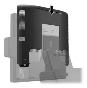
10. Rimettere il coperchio I/O posteriore collocando i ganci situati sul fondo del coperchio negli slot situati sul fondo dello chassis (1). Ruotare quindi verso l'alto il lato superiore del coperchio I/O in modo che scatti in posizione fissa nello chassis (2).
