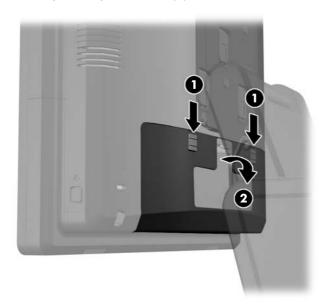
4. Spingere verso l'interno sulla linguetta in fondo al coperchio di protezione dell'USB (1) e ruotare il fondo del coperchio verso l'alto (2) per rimuoverlo.
