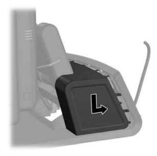
14. Rimettere il coperchio I/O posteriore collocando i ganci situati sul fondo del coperchio negli slot situati sul fondo dello chassis (1). Ruotare quindi verso l'alto il lato superiore del coperchio I/O in modo che scatti in posizione fissa nello chassis (2).
